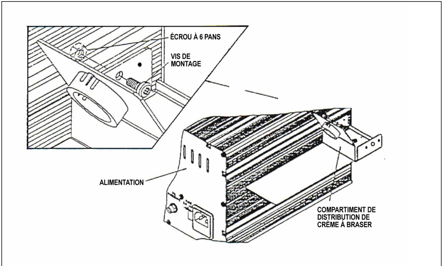
Figure 2. Montage du compartiment sur l'alimentation
