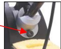
L'angolazione della custodia della manopola TD-100 può essere regolata allentando leggermente la vite di regolazione angolare, collocando la custodia nella posizione desiderata e serrando la vite di regolazione.
