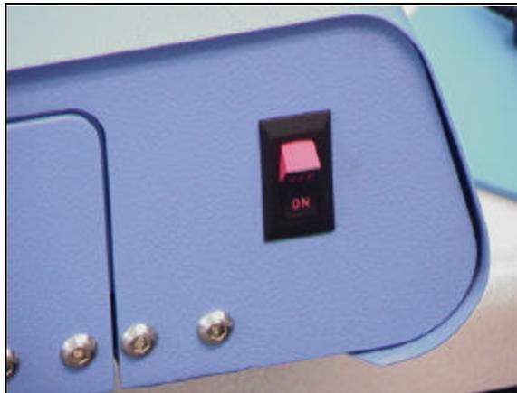
Abb 14. Hauptnetzschalter in Stellung EIN
