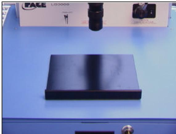
Abb. 12. Platzieren des Leiterplatten-Manipulators
