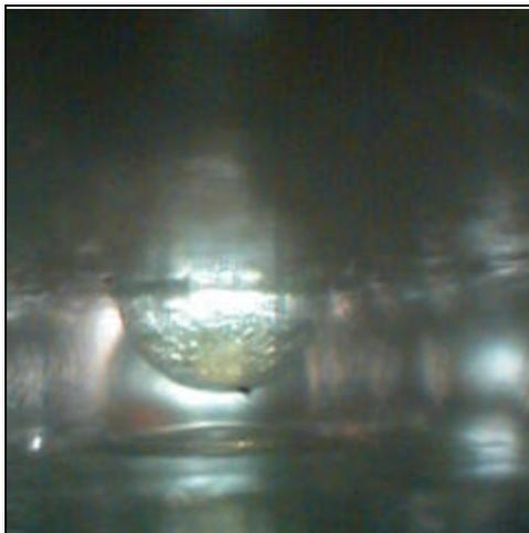
Eine nicht geschlossene Verbindung zwischen Komponente und Leiterplatte.
