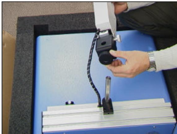
Abb. 4. Lösen der Grobjustierschraube
