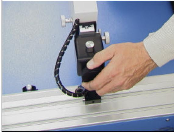
Abb. 5. Aufsetzen der Kamerakopfbaugruppe auf die Kameraführungssäule
