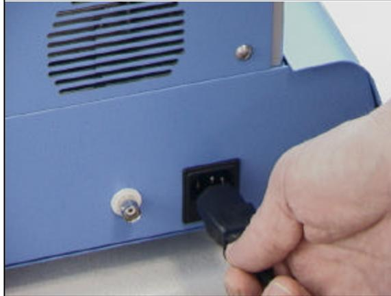
Abb 6. Anschließen des Netzkabels
