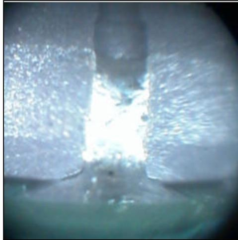
Ein Beispiel für eine Kehle an einer LCCC-Komponente.
