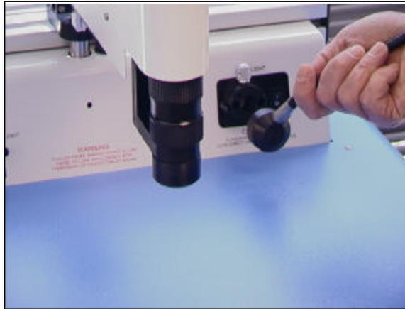
Abb 11. Anschließen der biegsamen Faserleuchte
