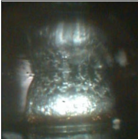
Überschüssiges Flussmittel, das sich nach dem Reflow an der Unterkante der Lötugel gesammelt hat.
