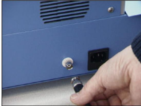
Abb. 8. Anschließen des Videokabels am LS 3000
