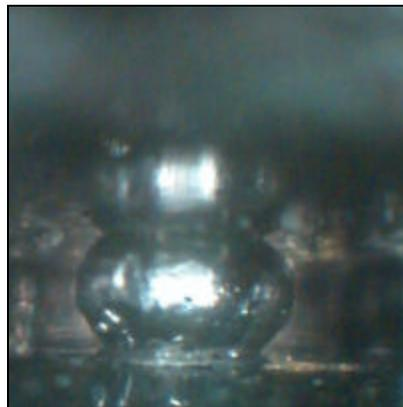
Eine gute Lötverbindung. Beachten Sie die geschlossene, blanke Kugeloberfläche und die guten Kehlen oben und unten.
