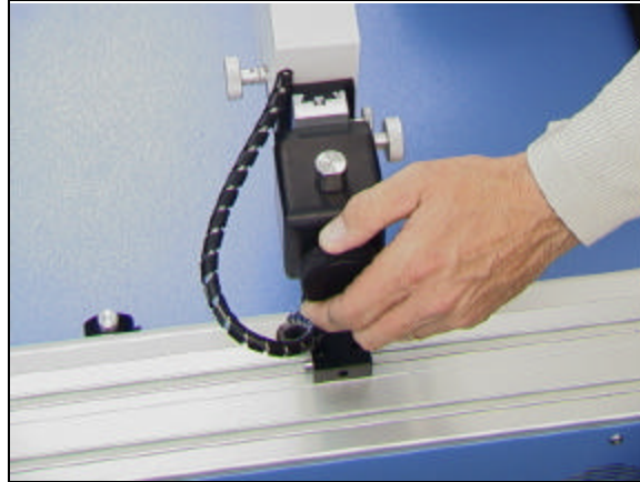
Figura 5: montaggio del gruppo della testa della camera sull'apposito supporto
