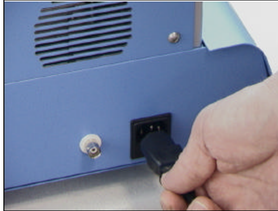
Figura 6: collegamento del cavo di alimentazione
