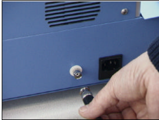
Figura 8: collegamento del cavo video al Sistema LS 3000
