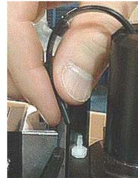
10. Girare il pomello in senso orario per installarlo sull'albero. Trattenere l'albero durante il serraggio per impedirgli di ruotare.
