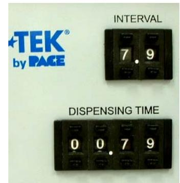
5. Regolare il tempo di intervallo mediante gli appositi tasti sul pannello frontale. Per la regolazione, premere il tasto "+" per aumentare il tempo e il tasto "-" per diminuirlo. Vi sono 2 cifre in tutto, con un intervallo variabile tra 0,1 e 9,9 secondi e una risoluzione di 0,1 secondi.
