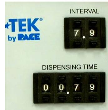
5. Ajuste el tiempo entre intervalos mediante los botones del panel frontal. Para ajustarlo, pulse el botón "+" para incrementar el tiempo y el botón "-" para reducirlo. Hay dos cifras en total, con valores que oscilan entre 0,1 y 9,9 segundos, mientras que la resolución es de 0,1 segundos.
