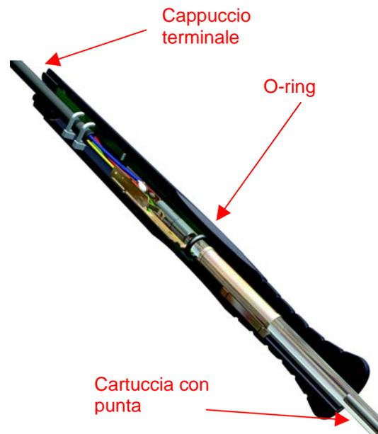
Non è necessario sostituire gli O-ring della manopola MT-100.
