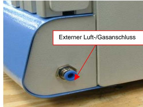
Abbildung 2: Externe Luft-/Gasversorgung an der Rückseite des TF 2500
