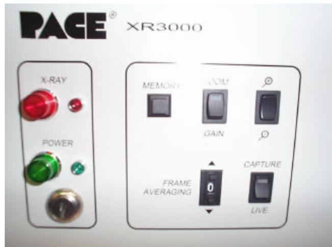
**Abbildung 3: Schalttafel des XR 3000**
