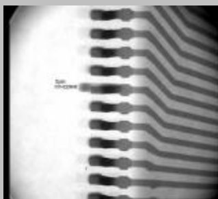
Falta de coplanaridad en componente con conductores
