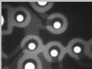
Descentrado agujero/placa en la tarjeta desnuda
