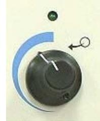
**REMARQUE :** La DEL du débit d'air variable s'allume lorsque la soufflante de la station ST 300 fonctionne.
